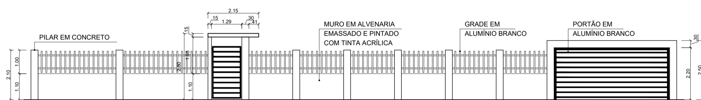
ELEVÇÃO - VISTA DO MURO esc.: 1:100
